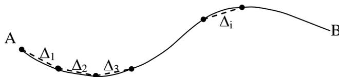
$\Delta t_i = \frac{\Delta_i}{c_i} = \frac{n_i \Delta_i}{c_0}$  où  $c_0$  est la vitesse de la lumière dans le vide,  $c_i$  et  $n_i$  la vitesse de la lumière et l'indice du milieu sur la partie  $i$  du parcours
