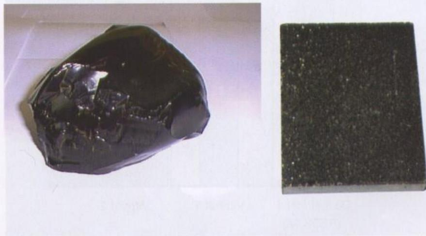
Figure 4. Vitrifiat de structure amorphe et exemple de recyclage dans le cadre de la fabrication de dalles de sols
