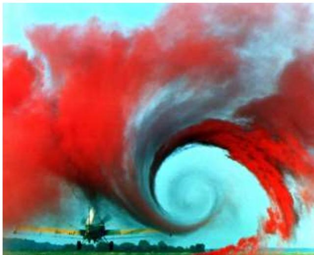
*Visualisation des tourbillons de sillage consécutive au passage d'un avion léger à travers un panache de fumée (Source NASA Langley Research Center - EL 1996 00130)*
